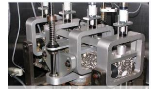
**Beam Fatigue Test**
